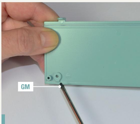
**111-3.** Befestigen Sie die Teile mit einer Schraube GM, die Sie von der Innenseite der Vorderwand aus festziehen.
