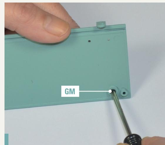
**111-5.** Sichern Sie die Teile, indem Sie eine Schraube GM in dem gezeigten Loch an der Innenseite der Vorderwand anziehen.
