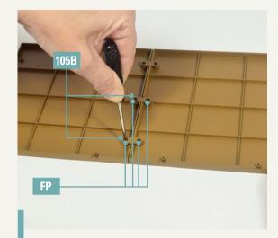
105-5. Bringen Sie zwei weitere Verbindungsstücke 105B in den angegebenen Positionen an und befestigen Sie sie mit vier Schrauben FP (zwei pro Verbindungsstück) an den Plattformen.
