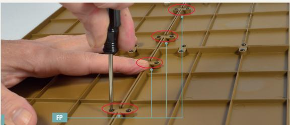
105-8. Befestigen Sie die Verbindungsstücke mit acht Schrauben FP (zwei pro Verbindungsstück).
