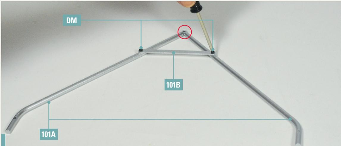
**101-1.** Verbinden Sie zwei abgewinkelte Zeltstangen 101A miteinander, indem Sie die Löcher an ihren geraden Enden überlappen lassen, wie durch den Kreis auf dem Foto angezeigt. Positionieren Sie ein Verbindungselement 101B wie gezeigt, sodass seine Löcher mit den beiden Löchern des Zeltstangen übereinstimmen, und befestigen Sie sie mit zwei Schrauben DM am Rest der Gruppe.
