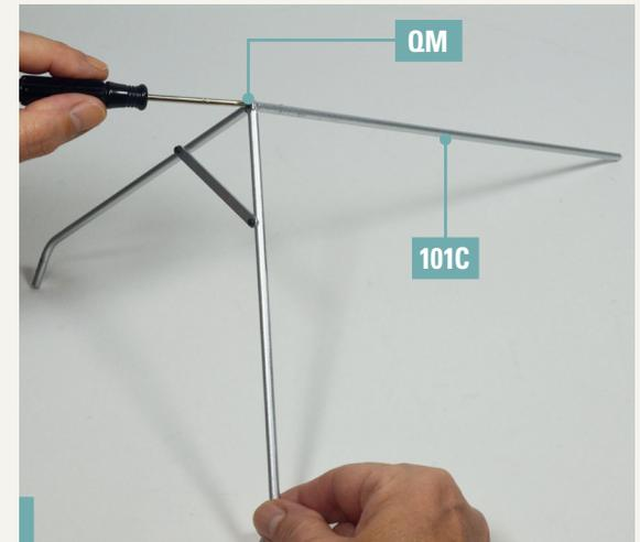
**101-2.** Platzieren Sie ein Ende einer geraden Zeltstange 101C hinter dem oberen Ende der abgewinkelten Zeltstangen. Richten Sie die Teile wie auf dem Foto gezeigt aus und befestigen Sie sie mit einer Schraube QM.
