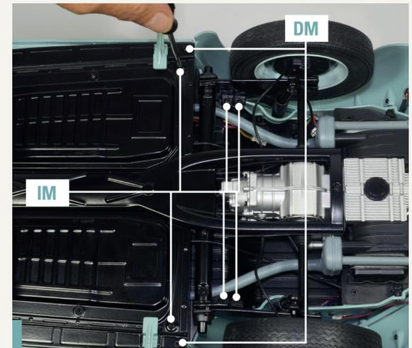
**90-7.** Schließen Sie die Befestigung des Fahrgestells am Rest des Modells ab, indem Sie zwei Schrauben DM und sechs Schrauben IM in den gezeigten Löchern festziehen.
