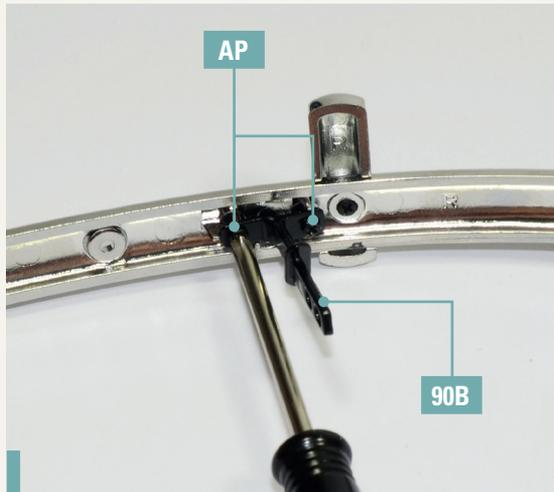
**90-12.** Montieren Sie nun die rechte Halterung 90B wie gezeigt und befestigen Sie sie mit zwei weiteren Schrauben AP.
