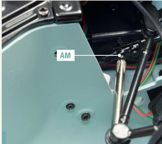
**90-9.** Ziehen Sie eine zweite Schraube AM im anderen Loch fest, um die Befestigung der Komponenten abzuschließen.
