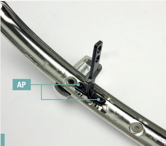
**90-11.** Befestigen Sie die linke Halterung mit zwei Schrauben AP an der Stoßstange.
