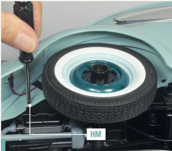
**90-2.** Beginnen Sie mit dem Zusammenbau, indem Sie eine Schraube HM (aus Ausgabe 88) in dem markierten Loch am rechten Hinterrad festziehen.
