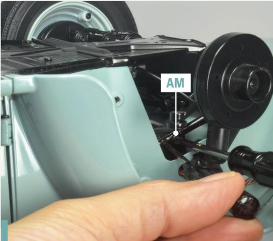
**90-8.** Passen Sie die flachen Flächen von Lenksäule und Lenkwelle aneinander an und beginnen Sie mit der Befestigung der Komponenten, indem Sie eine Schraube AM im gezeigten Loch festziehen. Stecken Sie die Spitze eines Schraubendrehers in das andere Loch, um die Ausrichtung der Teile stabil zu halten.
