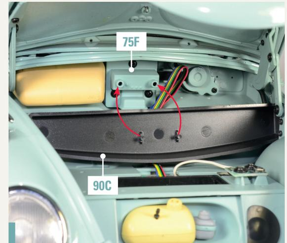
**90-13.** Stecken Sie die obere Trennwand 90C in der auf dem Foto gezeigten Position mit ihren beiden Stiften in die Säulen der Halterung der Leiterplatte 75F.
