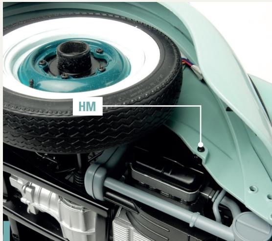
**90-3.** Ziehen Sie eine zweite Schraube HM in dem gezeigten Loch am linken Hinterrad fest.
