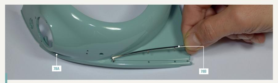
78-1. Setzen Sie die Zierleiste 78B in die Nut des rechten vorderen Kotflügels 78A ein. Richten Sie die Teile wie abgebildet aus, sodass die Stifte der Zierleiste mit den Löchern in der Nut des Kotflügels übereinstimmen.
