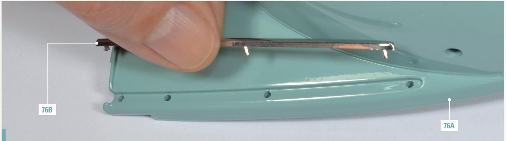
**76-1.** Setzen Sie die Zierleiste 76B in die Nut des linken vorderen Kotflügels 76A ein. Richten Sie die Teile wie abgebildet aus, sodass die Stifte der Zierleiste mit den Löchern in der Nut des Kotflügels übereinstimmen.
