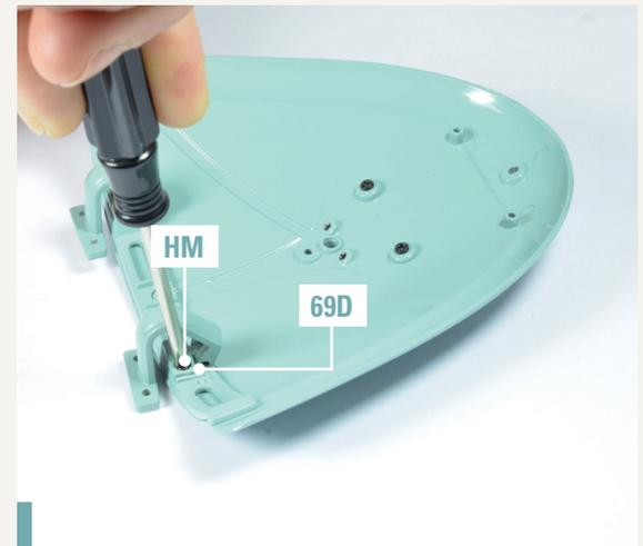
**69-10.** Setzen Sie das Scharnier der rechten Seite in die entsprechende Aussparung der Innenseite des hinteren Deckels ein. Passen Sie Teil B 69D an den Innenrahmen an und befestigen Sie die Teile mit einer Schraube HM.
