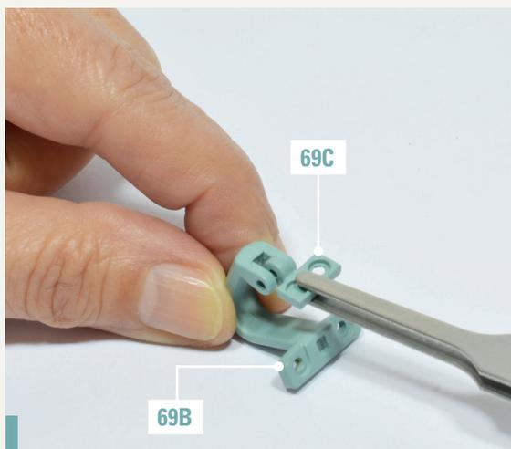
**69-3.** Stecken Sie ein Scharnier 69B (Teil A) in die Aussparung eines linken Scharniers 69C (Teil B). Richten Sie die Teile dazu wie abgebildet aus.
