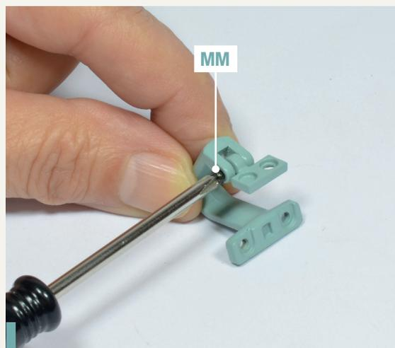
**69-4.** Verbinden Sie die beiden Scharnierteile mit einer Schraube MM.
