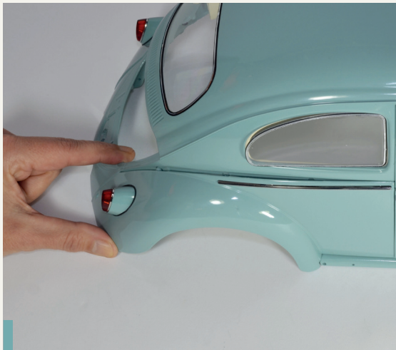
67-8. So sieht der korrekt montierte rechte hintere Kotflügel aus.
