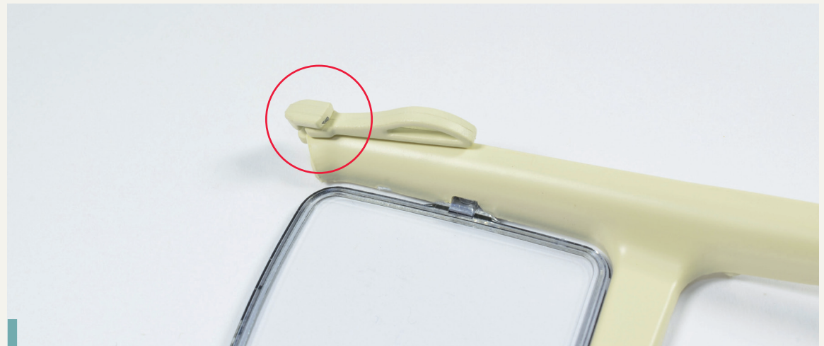
64-8. Montieren Sie die Halteschleife wie abgebildet am oberen Ende der Türsäulenverkleidung.
