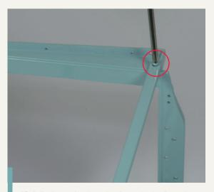
**60-6.** Entfernen Sie die rechte Schraube des Querträgers der vorderen Verstärkung.
