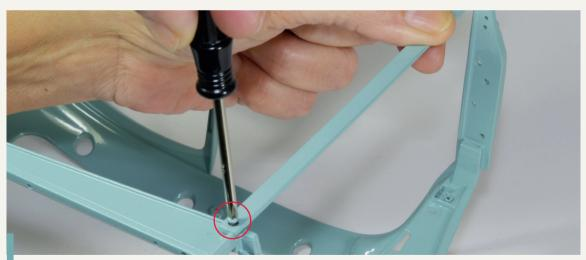
**60-7.** Entfernen Sie die linke Schraube des Querträgers der vorderen Verstärkung und trennen Sie ihn von der Karosserie. Legen Sie ihn zusammen mit dem hinteren Verstärkungsquerträger und den entfernten Schrauben beiseite.
