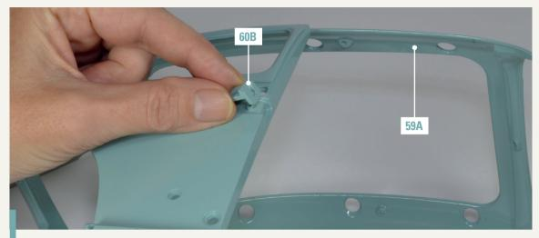
**60-1.** Nehmen Sie das Hauptteil der Karosserie 59A zur Hand und legen Sie es auf Ihre Arbeitsplatte. Setzen Sie die rechte Schließplatte 60B in die entsprechende Aussparung ein.
