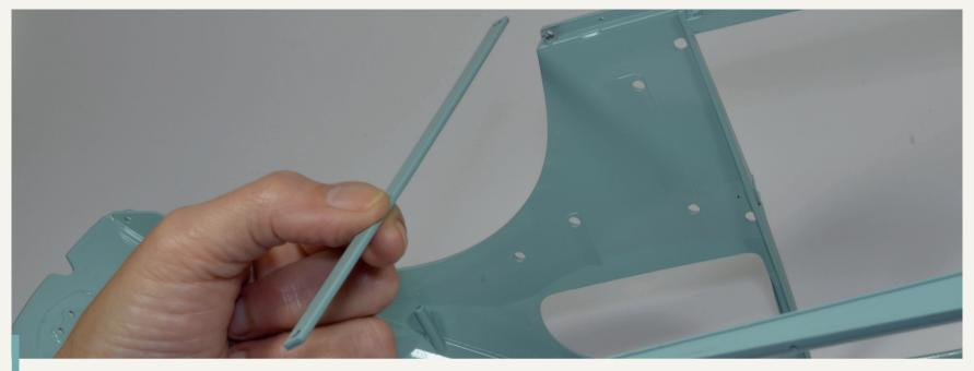
60-5. Trennen Sie den hinteren Querträger von der Karosserie und legen Sie ihn zusammen mit den entfernten Schrauben beiseite.
