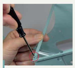
**60-4.** Entfernen Sie auf die gleiche Weise die linke Schraube des Querträgers der hinteren Verstärkung.
