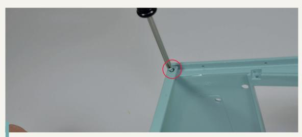
**60-3.** Drehen Sie das Hauptteil der Karosserie um. Entfernen Sie die durch den Kreis markierte rechte Schraube des Querträgers der hinteren Verstärkung.
