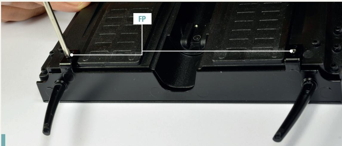
**42-4.** Befestigen Sie die Spritzwand am Bodenblech, indem Sie jeweils eine Schraube FP in das größere Loch an jeder Halterung eindrehen. Vergleichen Sie anhand des Fotos, ob die Bauteile korrekt ausgerichtet sind.
