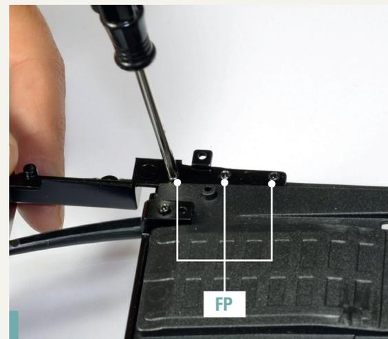
**42-13.** Schließen Sie die Befestigung der Teile ab, indem Sie drei weitere Schrauben FP in den auf dem Foto markierten Löchern auf der anderen Seite der Baugruppe festziehen.
