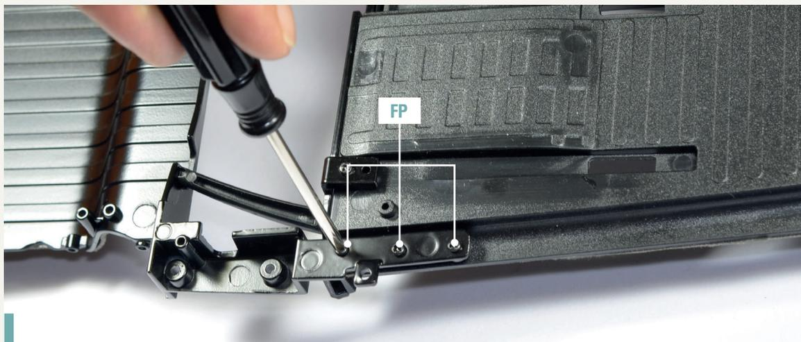
**42-12.** Beginnen Sie mit der Befestigung des Kofferbodens am Bodenblech, indem Sie drei Schrauben FP in den auf dem Foto markierten Löchern nach und nach anziehen.
