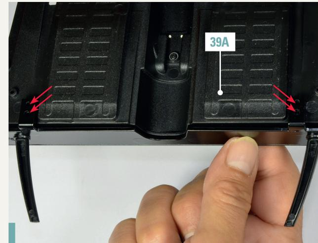
**42-3.** Nehmen Sie das Vorderteil des Bodenblechs 39A zur Hand und verbinden Sie es mit der Spritzwand. Richten Sie die Löcher der beiden Spritzwandhalterungen an den Löchern auf der Unterseite des Bodenblechs aus, wie durch die Pfeile in der Abbildung gezeigt.
