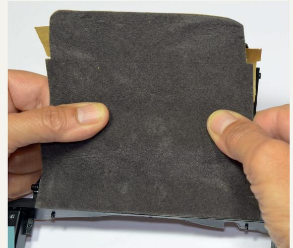
**42-8.** Klappen Sie den Teppich zurück auf die Oberseite des Kofferbodens und ziehen Sie nach und nach die Schutzfolie ab. Stellen Sie dabei sicher, dass sich keine Wellen bilden und die Kanten korrekt ausgerichtet sind.
