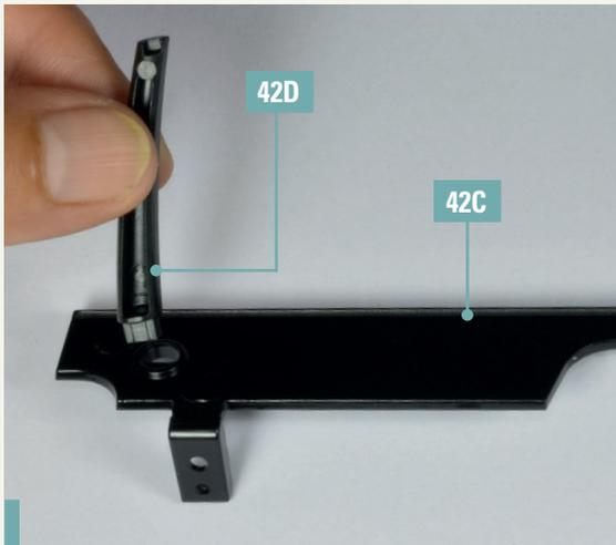
**42-1.** Setzen Sie das linke Heizungsrohr 42D (gekennzeichnet mit einem „L“) in die entsprechende Öffnung der Spritzwand 42C. Richten Sie die Teile wie auf dem Foto gezeigt aus.
