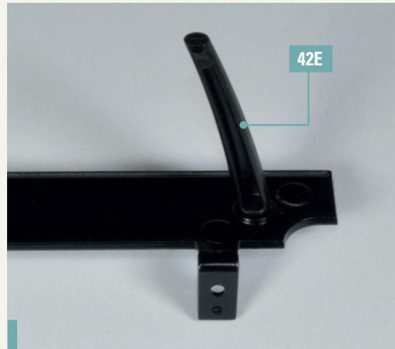
**42-2.** Montieren Sie das rechte Heizungsrohr 42E (gekennzeichnet mit einem „R“) am anderen Ende der Spritzwand.
