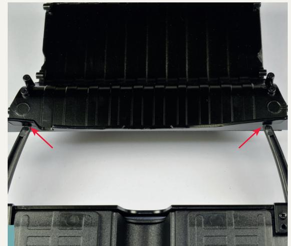
**42-11.** Stecken Sie die freien Enden der Heizungsrohre auf die Stifte des Kofferbodens.
