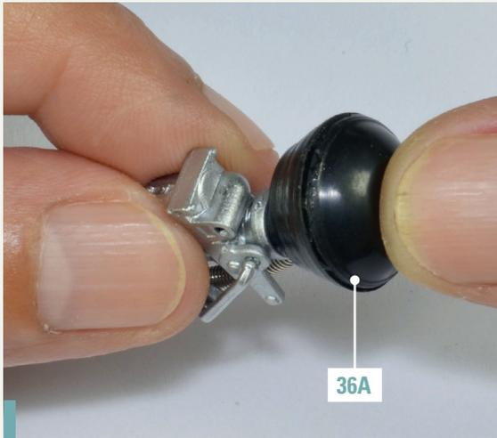
**36-10.** Befestigen Sie auch den oberen Teil des Luftfilters 36A am Rest der Baugruppe.
