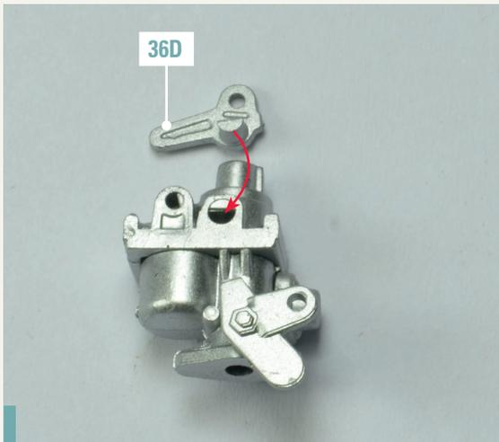
**36-4.** Verbinden Sie den Luftklappenhebel 36D mit dem Vergaser in der auf dem Foto gezeigten Position.
