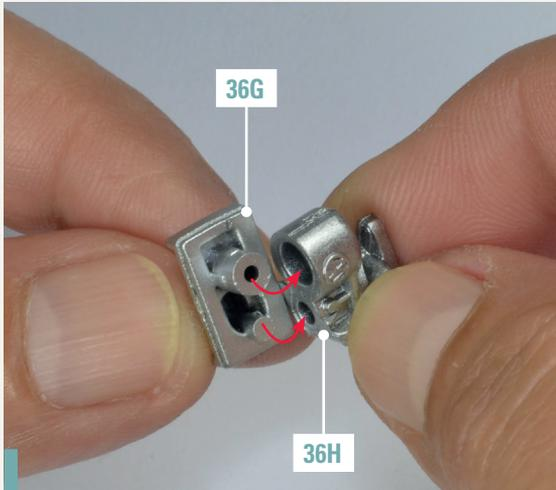
**36-1.** Verbinden Sie beide Teile des Vergasers (36G und 36H) miteinander, indem Sie sie wie auf dem Foto gezeigt ausrichten.
