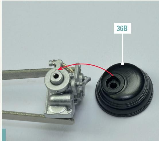
**36-8.** Montieren Sie den unteren Teil des Luftfilters 36B in der auf dem Foto gezeigten Position auf den entsprechenden Stift des Vergasers.
