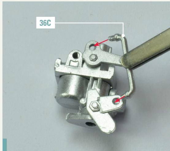
**36-5.** Verbinden Sie die beiden Hebel miteinander, indem Sie die Verbindungsstange 36C wie auf dem Foto gezeigt anbringen.
