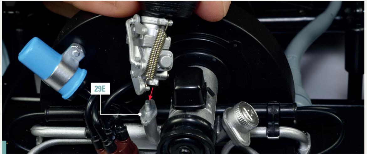
**36-11.** Nehmen Sie das Fahrgestell Ihres Modells zur Hand und montieren Sie die Vergaser-Baugruppe auf Teil C des Saugrohrs 29E.
