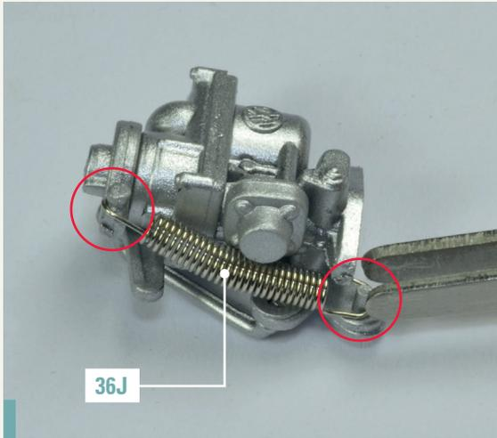
**36-7.** Verbinden Sie die Feder 36J mit dem Rest der Baugruppe, indem Sie ihre beiden Enden an den durch die Kreise auf dem Foto hervorgehobenen Stiften einhängen.
