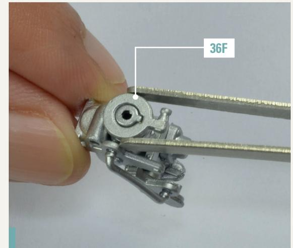
**36-6.** Setzen Sie den Dichtring 36F auf den entsprechenden Stift des Vergasers auf.
