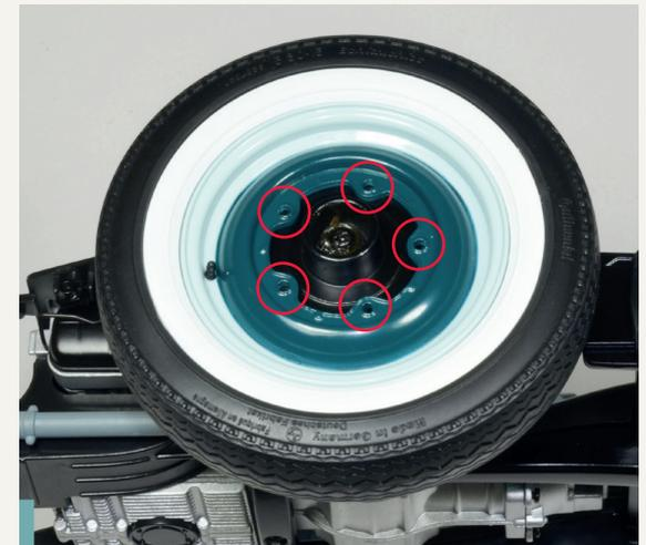
**28-7.** Drehen Sie das Rad, bis die fünf Löcher der Außenfelge und der Außenteil der Trommelbremse, die in der Abbildung durch die roten Kreise gekennzeichnet sind, aufeinander ausgerichtet sind.
