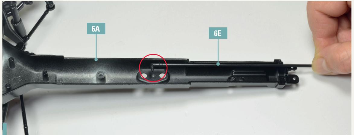
**6-8.** Abschließend wird die Schaltstange 6E an der Innenseite des Zentralrohrs 6A befestigt. Richten Sie die Teile wie abgebildet aus und stecken Sie den Stift des Zentralrohrs in das Loch der Schaltstange.
