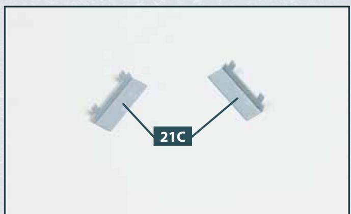
**6** Biegen Sie die beiden Abdeckungen **21C** mithilfe der Flachzange entlang des Falzes etwa im 45°-Winkel.
