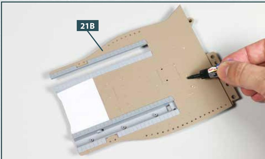
**2 Methode 1– Sekundenkleber (Cyanacrylat):** Versehen Sie die Oberseite des Flugdecks **21B** mit lauter kleinen Klebepunkten. Achten Sie dabei darauf, nur den Bereich mit Kleber zu versehen, der vom Decksbelag verdeckt werden wird.
