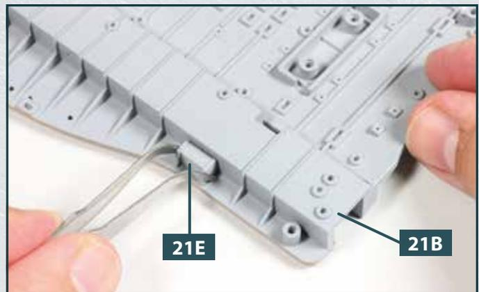
**2** Nehmen Sie das Anbauteil **21E** und versehen Sie dessen zwei Aufnahmen mit etwas Sekundenkleber. Setzen Sie diese auf die Zapfen am linken Rand des Flugdecks **21B**.
